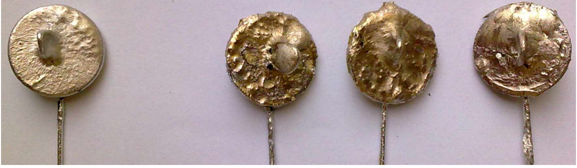
Şekil 5.24. D numunesinin 750 °C - 5dk şartlarında kaplamada oluşan kusurlar.
